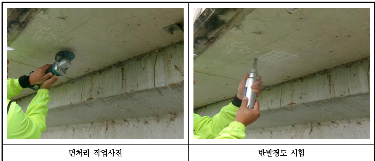
【사진 8.4.2】 반발경도시험 현장사진
